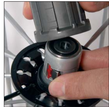
Speichen-Schutzscheibe auf den Nabenkörper setzen, Sperrklinken zusammen drücken und den Freilaufkörper wieder in den Nabenkörper einsetzen.
