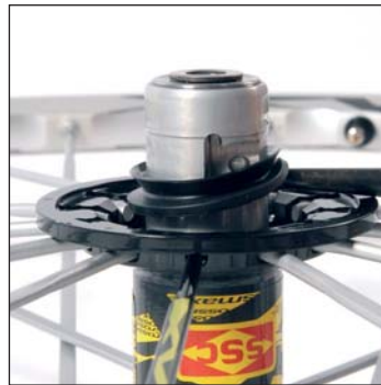
Lippendichtung vorsichtig mithilfe des spitzen Dorns demontieren.
