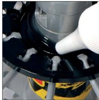
Innenverzahnung im Freilaufkörper schmieren, indem 2 bis 3 Nuten mit Öl gefüllt werden. Ein paar Tropfen Mavic-Mineralöl M40122 gehören auch auf die Lippendichtung.
